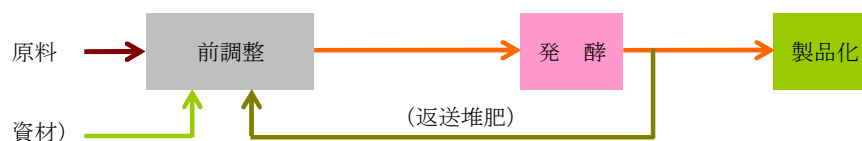
図 5-3 堆肥化設備の標準フローシート
